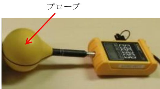
図1 使用した磁界測定器 (Narda S.T.S.社製 ELT-400)
