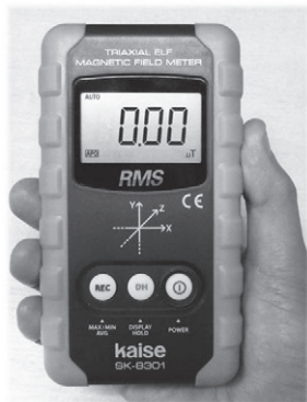
低周波磁界測定器 (kaise SK-8301) 測定レンジ：0～200 \mu\text{T} 周波数範囲：40～1,000 Hz 単位は \mu\text{T} と mG で表示可能
